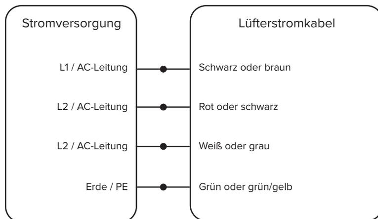
Bei einem Dreiphasenanschluss (auch: „Drehstrom“) mit 120/240 Volt Wechselstrom müssen die Anschlüsse (mit einer orangefarbenen Markierung gekennzeichnet) **UNBEDINGT** an die L3-Leitung des Stromkabels angeschlossen werden. Der Anschluss an ungeerdete Transformator-Sekundärleitungen mit 480 Volt Wechselstrom ist nicht zulässig.
