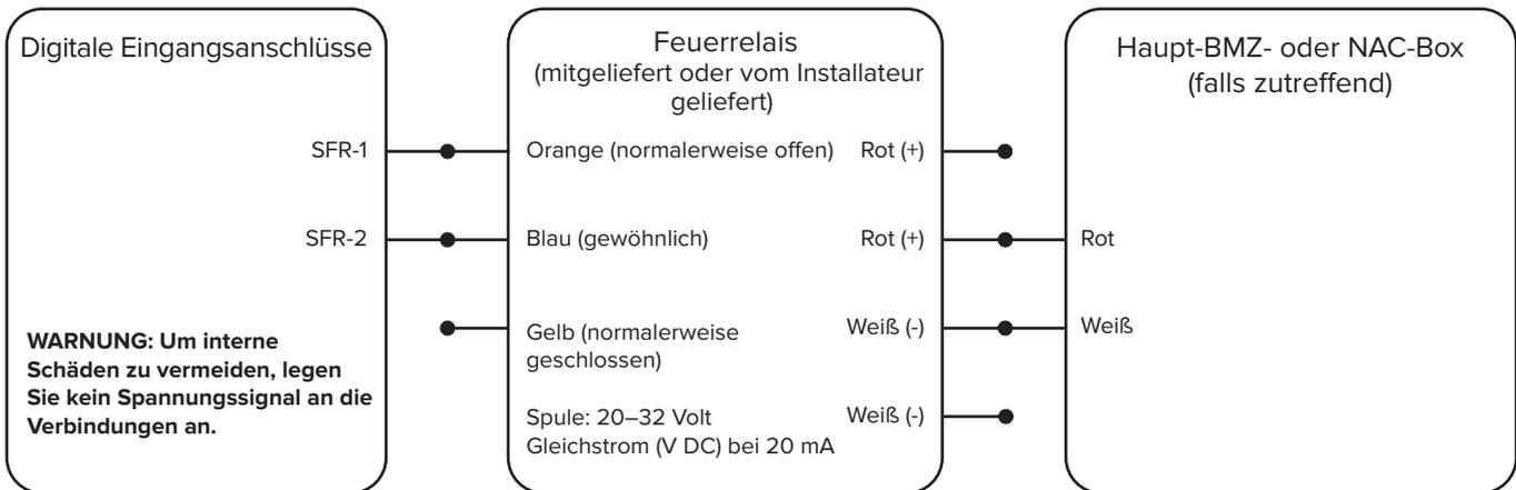
Ein Kontaktschluss zwischen den digitalen Eingangsklemmen SFR-1 und SFR-2 führt zur Abschaltung des Lüfters. Die Relaispule muss von der BMZ mit 24 V DC versorgt werden, damit der Lüfter abgeschaltet werden kann. Dies geschieht mit einem Satz roter (+) und weißer (-) Drähte. Der andere Satz roter und weißer Drähte dient zur Weitergabe des Signals an den nächsten Lüfter (überwachte Durchschaltung). Ein Alarmzustand stoppt den Lüfter und gibt einen Fehler an die Steuerung aus.
