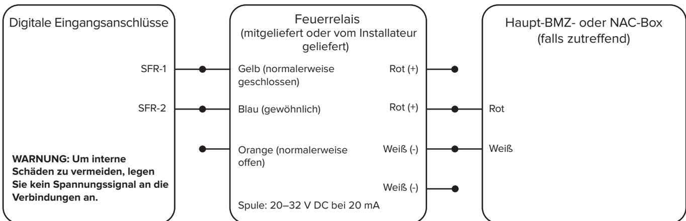
Die Relaispule muss für den Lüfterbetrieb von der BMZ mit 24 V DC versorgt werden. Das gilt als ausfallsichere bzw. ausfalloffene Verdrahtungsanordnung. Dies geschieht mit einem Satz roter (+) und weißer (-) Drähte. Der andere Satz roter und weißer Drähte dient zur Weitergabe des Signals an den nächsten Lüfter (überwachte Durchschaltung). Ein Alarmzustand stoppt den Lüfter und gibt einen Fehler an die Steuerung aus.
